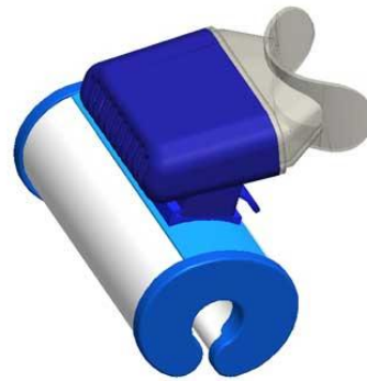
Figur 4. Filter med stor area och liten volym.
